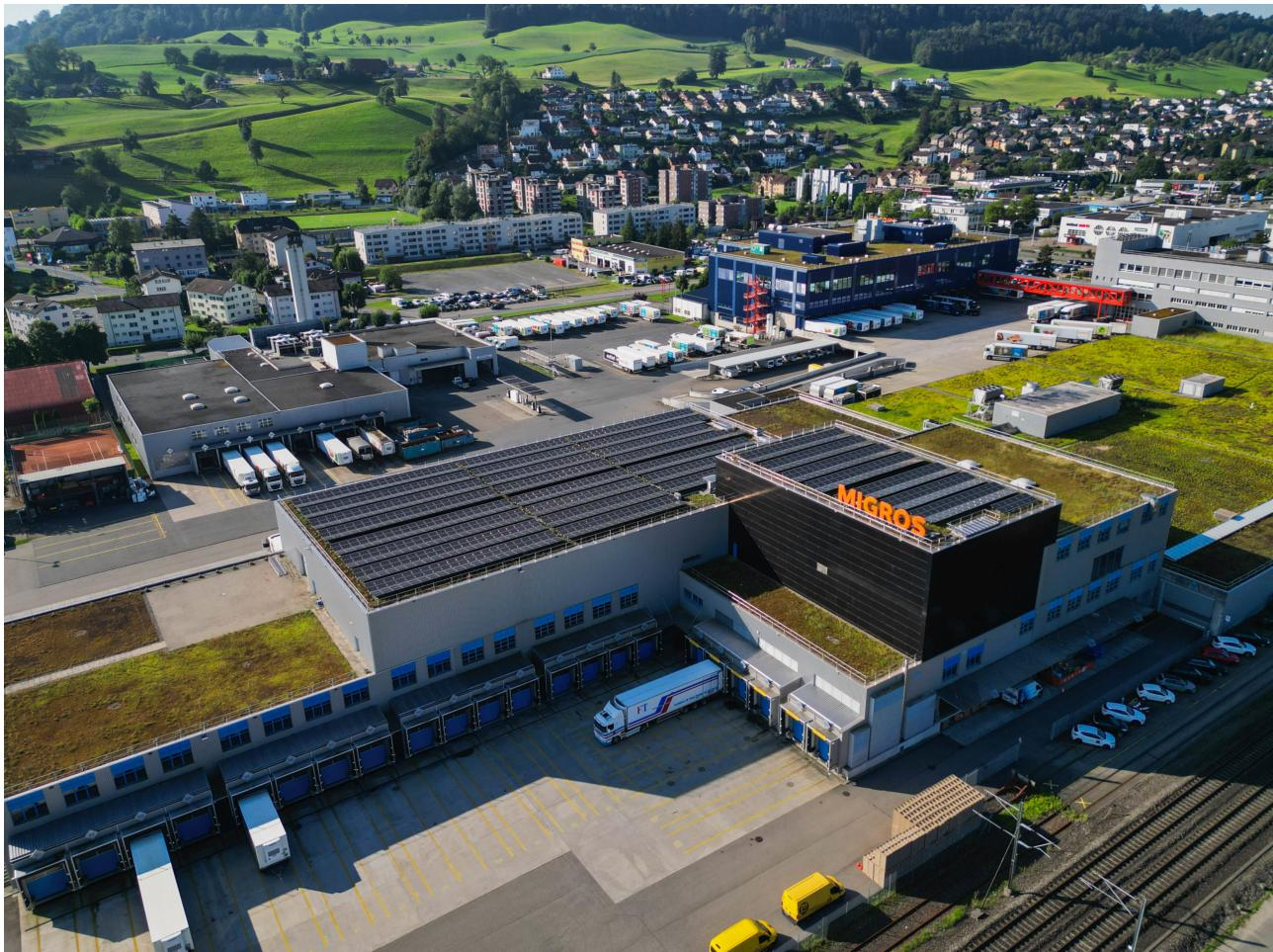
**Fläche in m<sup>2</sup>: 2720 | Leistung in kWp: 537 | Realisation: 2021**
